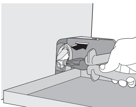
6. Когда вода перестанет литься, отвинтите против часовой стрелке крышку фильтра и плоскогубцами извлеките фильтр. Всегда держите под рукой тряпку, чтобы вытереть воду, которая может пролиться при снятии фильтра.
