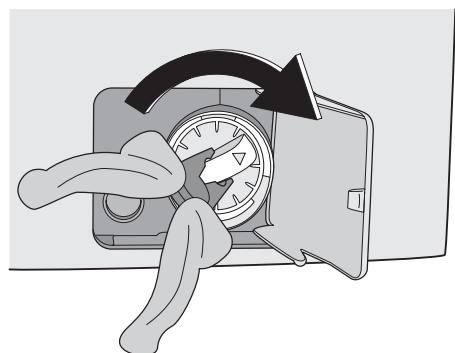
10. Установите на место заглушку отверстия аварийного слива и плотно закрепите ее.
