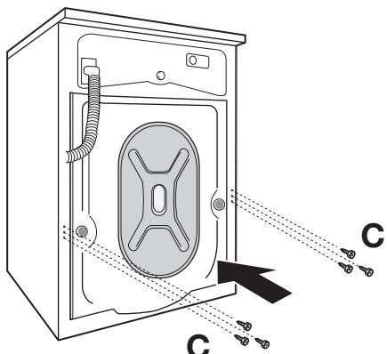
6. Откройте дверцу, достаньте наливной шланг из барабана и снимите по-
