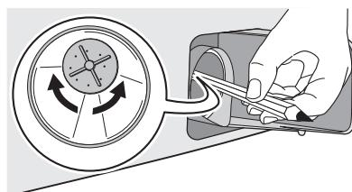
9. Вставьте фильтр в правильном положении, используя специальные направляющие. Плотно закрутите крышку насоса, вращая ее по часовой стрелке.
