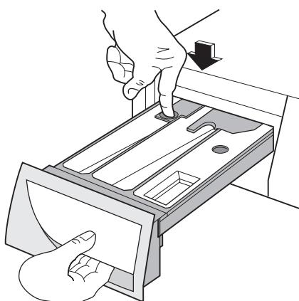
Промойте его проточной водой, чтобы удалить все остатки скопившегося порошка.
