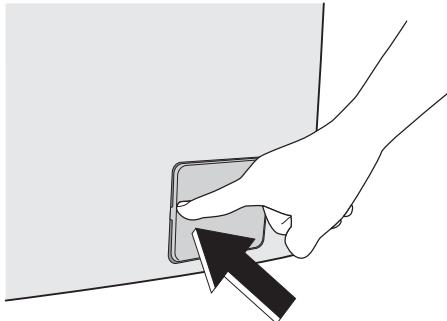
**ВНИМАНИЕ!** При работающем приборе в зависимости от выбранной программы в сливном насосе может быть горячая вода. Никогда не снимайте крышку сливного насоса во время стирки, всегда дожидайтесь, чтобы прибор завершил цикл и спил воду. При установке крышки на место убедитесь, что она плотно затянута во избежание утечек и возможности снятия ее детьми.
