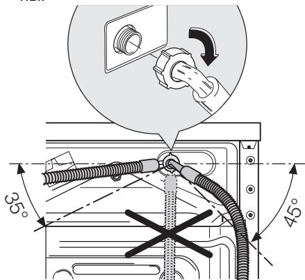
3. Отрегулируйте положение шланга, ослабив зажимную гайку. Отрегулировав положение шланга, не забудьте плотно затянуть зажимную гайку во избежание утечек.
